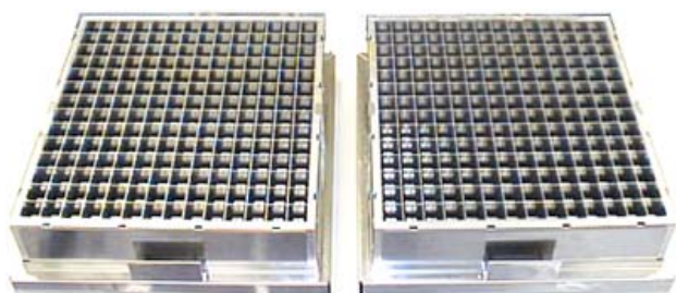
集塵ユニット 微細な浮遊粉塵を電気集塵により捕集します。電離ポイントとコレクターセルのセットで集塵ユニットと呼びます。 時間の経過とともに汚れが付着しますので定期的に洗浄が必要です。
